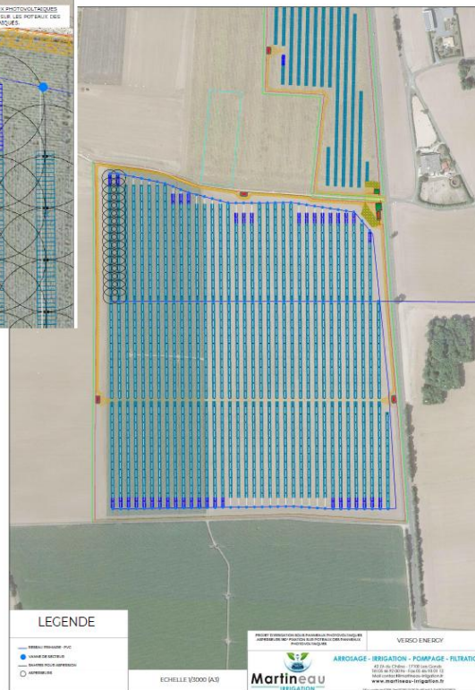
Plan d'irrigation avec la technologie asperseurs à 180°, fixés sur les pieux des structures photovoltaïques.
